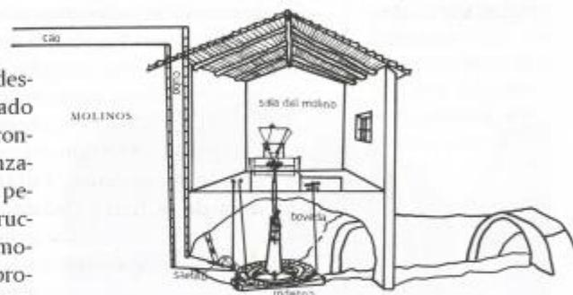
Esquema de molino (de rodezno con cubo).
