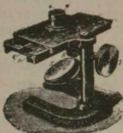
Fig. 58.—Hemómetro de FLEISCHL, y pipeta
