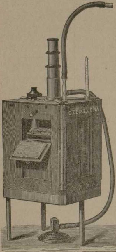
Fig. 19.—Caja calentadora de ZEISS.
