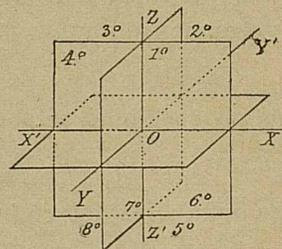
Modo de fijar analíticamente la posición de una recta.
