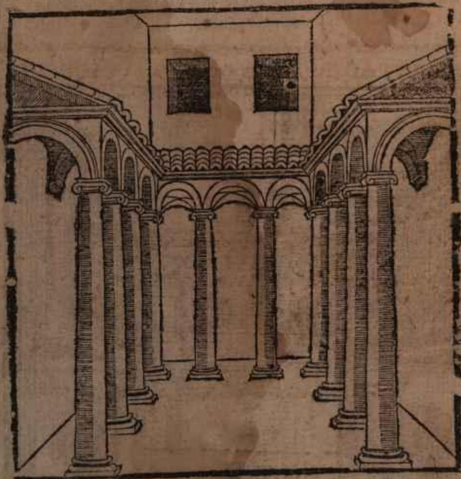
Tetrafilos edificios son aquellos, en los quales puestas debaxo de vigas columnas angulares, dan prouecho a las vigas, y firmeza, porq̃ las vigas no son forçadas a sostener grande impetu, ni se cargan de las otras que estan puestas sobre ellas.
